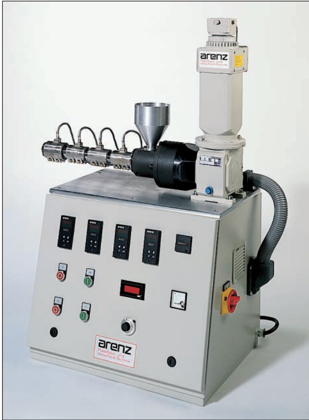
Extrudeuse de laboratoire Arenz
