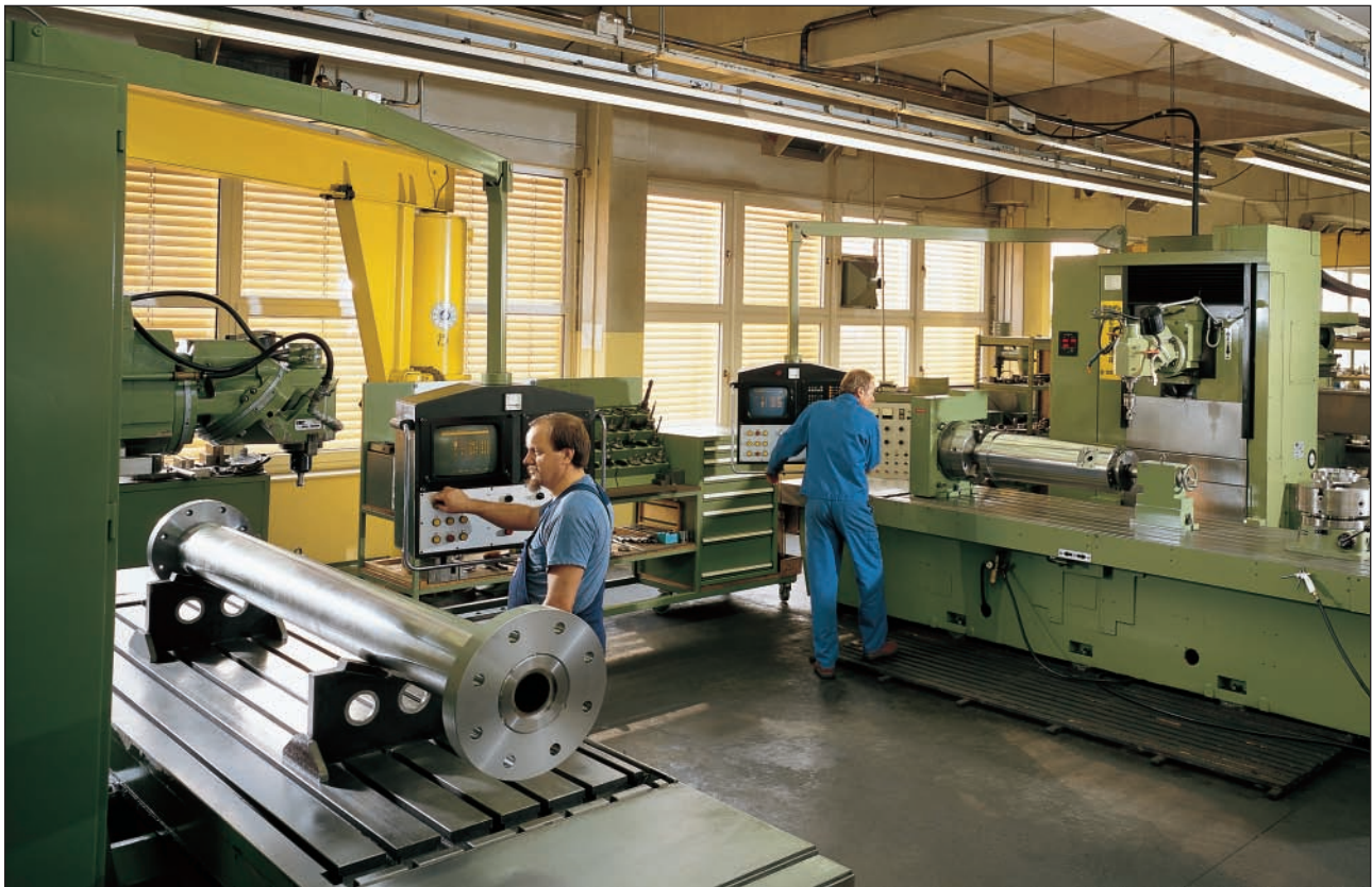
Centre d'usinage pour cylindres en différentes versions.
