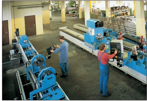
Centre de forage long et de rodage avec des moyens de haute technologie.
